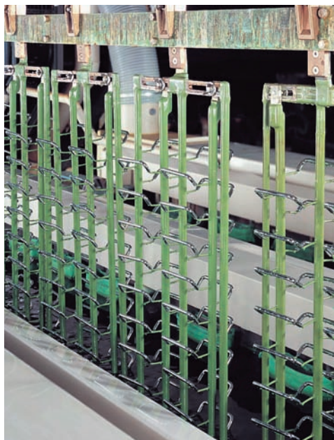
Werkbild: Rohde Rund-Stahlgriffe Typ ST im Galvanoautomat nach dem Vernickeln Picture made by: Rohde Round steel rod handles typ ST after nickel plating in the automatic electroplating plant
