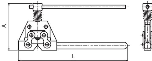
ローラーチェーンのプレートとピンをはずしてチェーンの切断を容易にしています。
