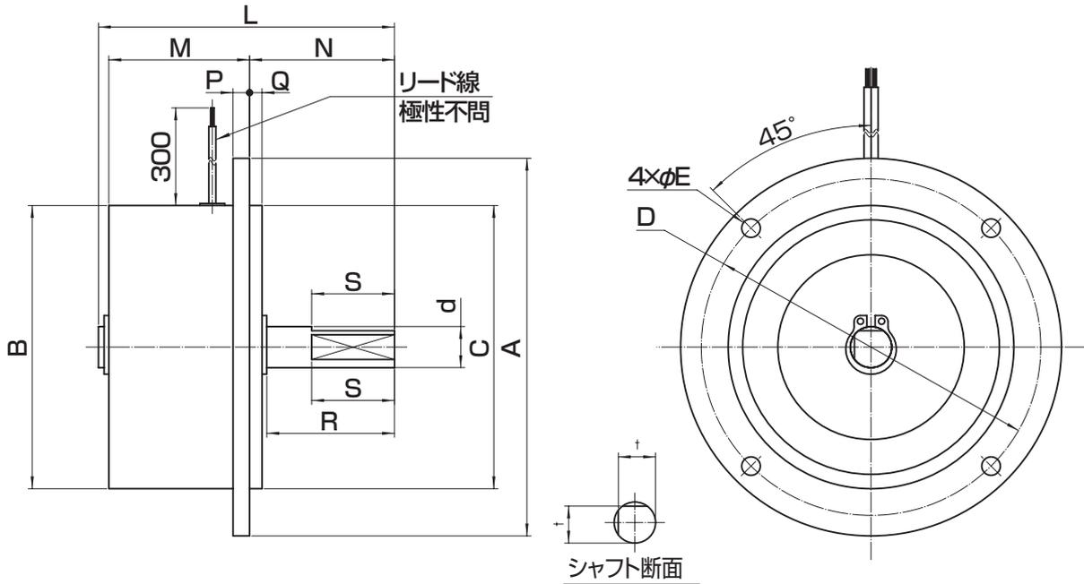
※使用姿勢は軸が水平に限定していますので、縦軸および斜軸では使用しないでください。
