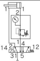
例2.エアの供給を停止し、レギュレータの入口圧力を大気開放する場合、安全対策上、レギュレータの出口側エアの残圧排気ができます。
